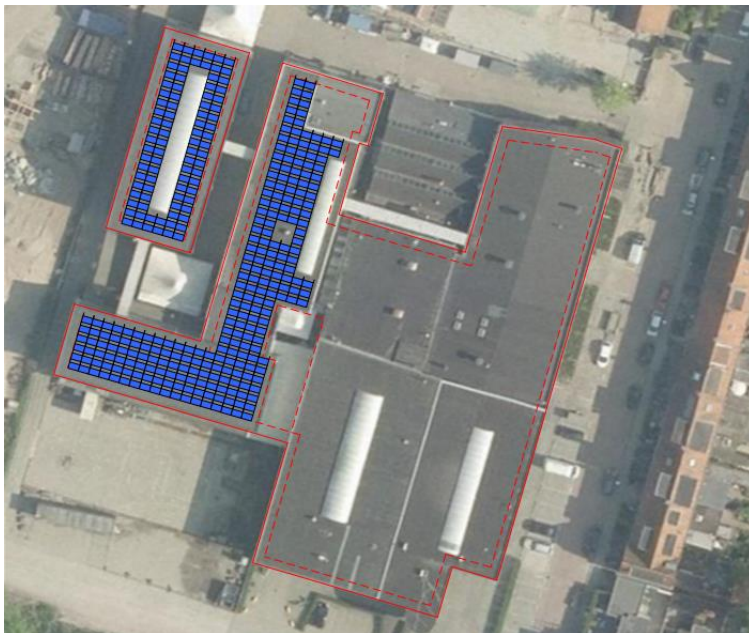
Weergave van de te realiseren zonnepanelen
